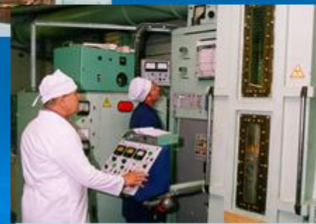
Стендовый комплекс для коррозионных испытаний материалов в жидкометаллических теплоносителях
