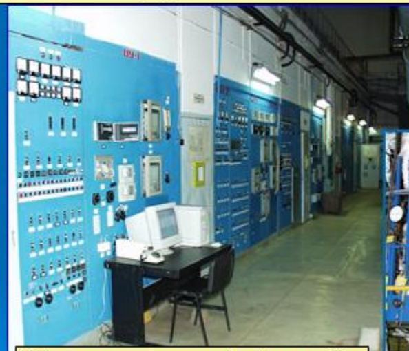
Стендовый комплекс для коррозионных испытаний материалов в жидкометаллических теплоносителях
