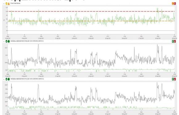
Параметр 10PAC01CY008, 10PAC01CY010 - синхронные скачки значений виброскорости верхнего и нижнего подшипника насоса ЦН-1. Максимальный скачок виброскорости - 28.09.2021г. с 1.6 мм/сек до 2.1 мм/сек продолжительностью 2,5 часа.
