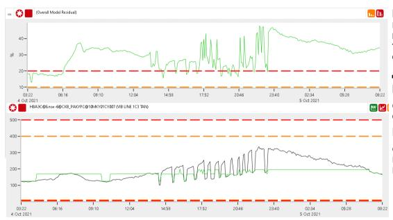
Колебательные изменения вибропараметров обмотки статора — виброконтроль состояния выводов и торцевого крепления обмотки статора со стороны турбины.
